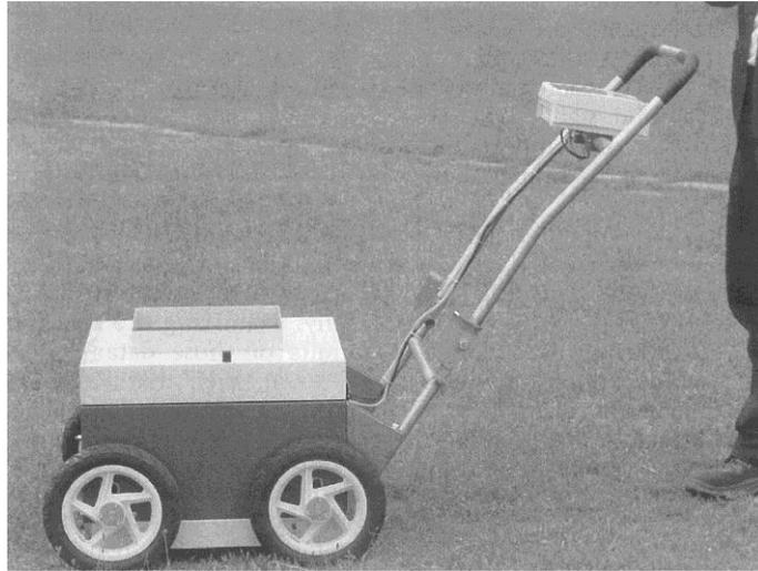
圖 3 地面放射性污染偵檢系統
