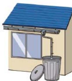
圖 2 屋瓦以高壓水淨洗除污，並將除污的排水回收之例子
