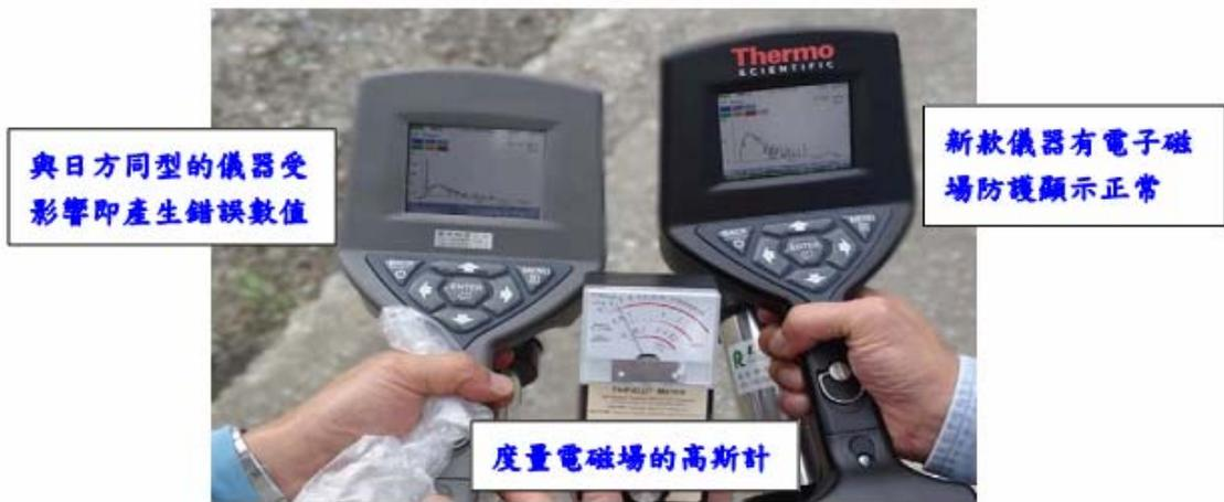
圖五：BNC SAM-940(左)與新公司製造同款的儀器(右)比較，BNC 易受電子磁場的影響，在朗島將兩部儀器對準基地台即有明顯差異。
