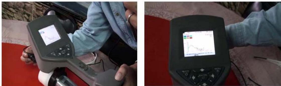
圖十：BNC SAM-940 在充電時，會因插入充電插座，造成內部電子磁場，而顯示錯誤數值。插入充電器線路前未出現突波(右圖)，插入充電器線路後，出現突波(左圖)
