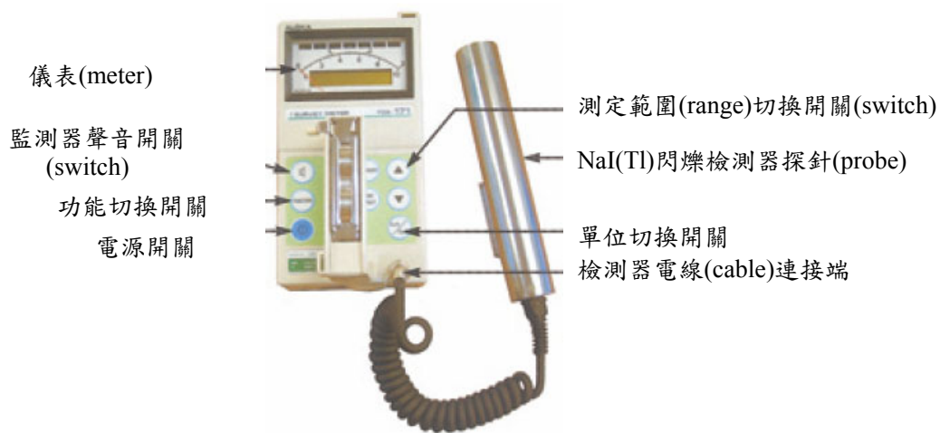
圖 2-27 NaI(Tl)閃爍式輻射偵測器
