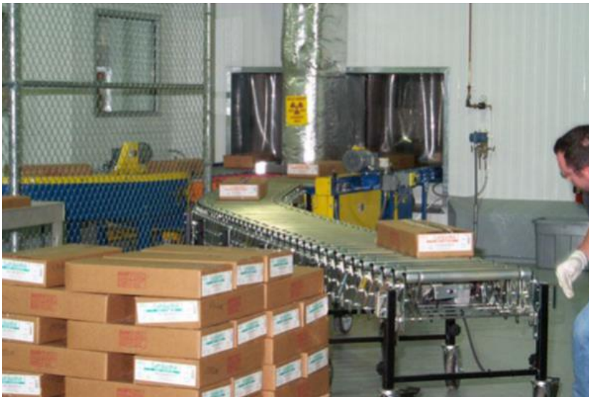
輸送帶上是接受電子束照射後的食物包裝箱
