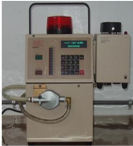
圖 13、空浮污染監測器之比例型(左)及碘化鈉(右)偵檢器
