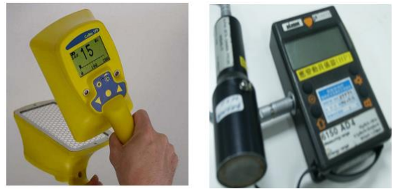
圖 14、輕便型表面污染偵檢器外觀
