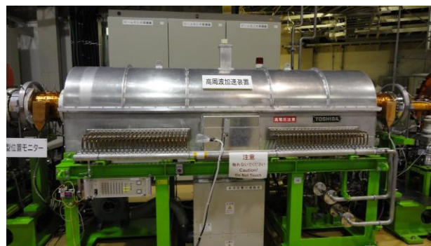
圖四 同步加速器中加速環中的微波加速管 (NIRS)。
