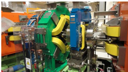
圖五 同步加速器中加速環與運輸線使用雙極磁鐵(左)偏轉射束、四極磁鐵(中)聚焦射束磁鐵(群馬大學重粒子醫學中心)。
