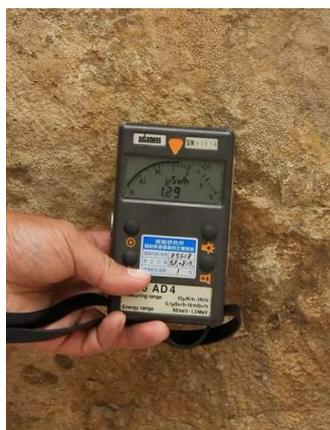
筆者接受委託分析市售的北投石手珠鍊，發現除了顏色不對之外，裡面的放射性物質只有鈾 232，研判應該是以負離子粉壓製而成的人造石。當我們以輻射偵檢器偵測表面劑量率時，竟高達  $1 \mu\text{Sv/h}$ ，比上述的負離子圓片更高。
