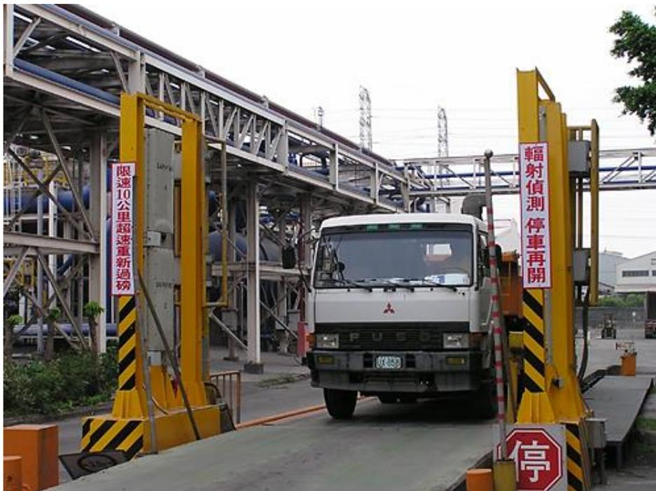
圖 2 門框式輻射偵檢系統
