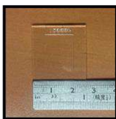
圖 1：左圖顯示了由 Intercast Europe Co. 製造的 CR-39 底片，其尺寸為 2.5 \times 2.5 \times 0.15 \text{ cm}^3 。右圖顯示了 CR-39 中各個化學元素的占比。
