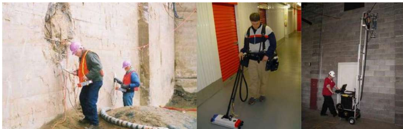
圖 1-表面污染掃描辨識熱點
