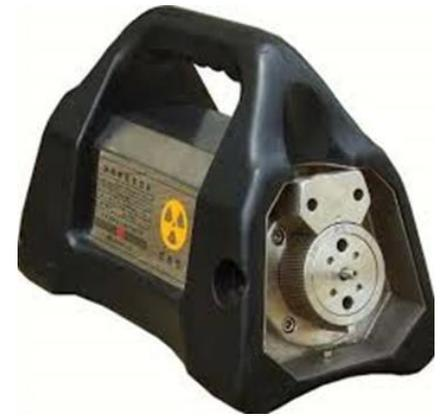
圖二 手提式 Ir-192 非破壞檢驗照射器
